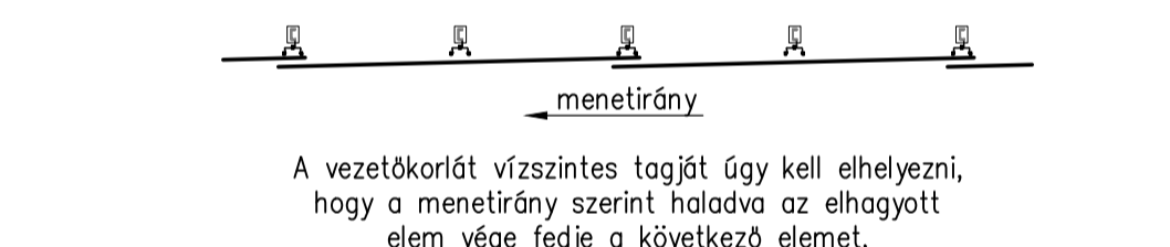
VÍZSZINTES KORLÁTELEMEK ELHELYEZÉSE
