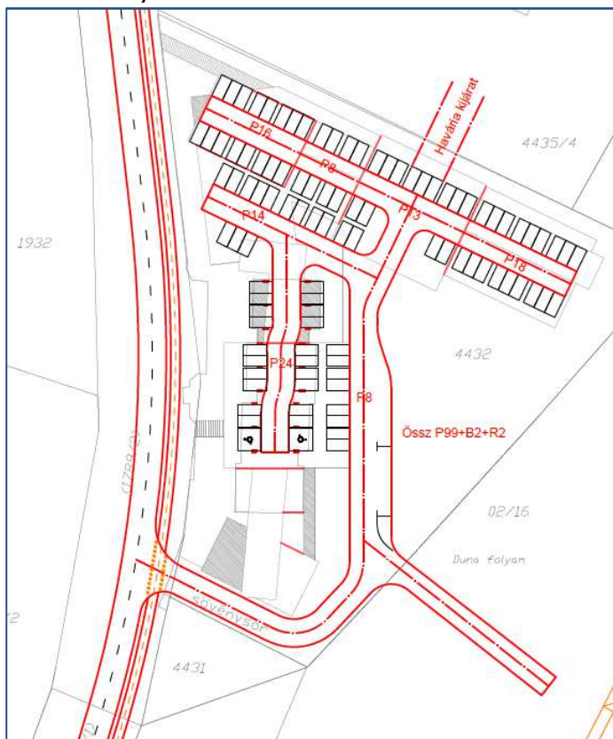
A telken belül az épület körül és a parkoló szinten tervezett gépjárművek közlekedését bemutató helyszínrajz
